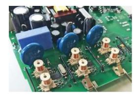
Blick in einen Stromzähler: Im Vordergrund deutlich zu sehen ist je Phase ein doppelter Aufbau von Rogowskispulen nebst Mess-IC vom Typ STPM01, der die Messdaten (W, VAR, VA, I<sub>ms</sub>, V<sub>ms</sub>, V und I) für seine jeweilige Phase ermittelt und bereits digitalisiert an den zentralen Speicher mit Display im oberen Teil des Zählers weiterleitet.
