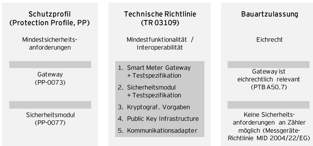
Abbildung 3: Prüfanforderungen Smart Meter Gateway
